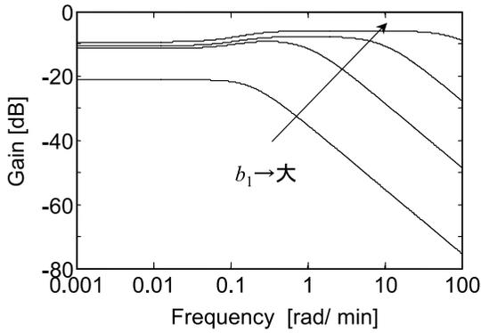
(a)  $b_1$ を変化させたときの $z_y/r$ のボード線図
