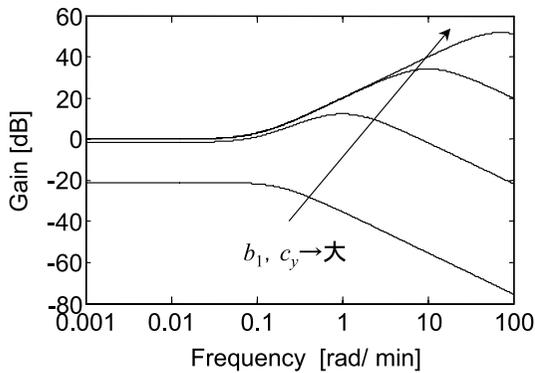
(b)  $b_1, c_y$ を変化させたときの $z_y/r$ のボード線図
